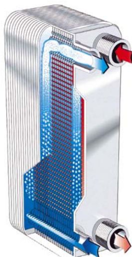
Princip průtoku výparníkem
